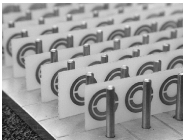
Рис. 5. Комбинация структур с отрицательной диэлектрической и отрицательной магнитной проницаемостями (экспериментальная реализация) [1]
