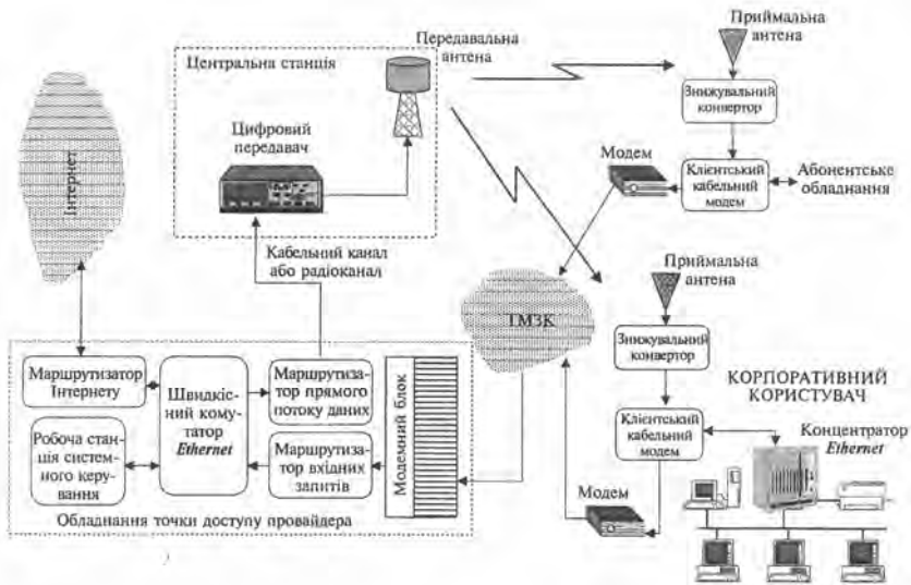
Рис. 5. Структурна схема реалізації швидкого одно направленного беспроводного доступа в Интернет для ШМРС
