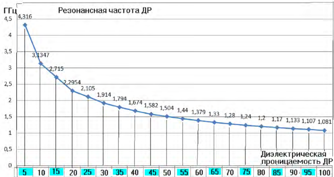
Рис. 8. Зависимость резонансной частоты ДР от относительной диэлектрической проницаемости.
