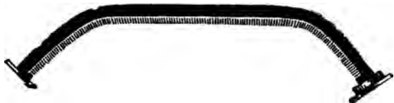
Рис. 4.38. Секция гибкого волновода (бесшовный гофрированный волновод)
