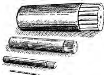
Рис. 5.19. Фильтр поглощающего типа волны H_{01}
