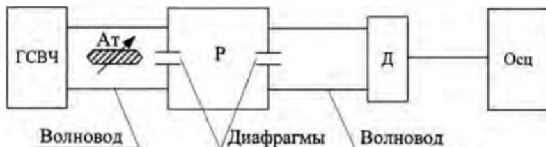
Рис. 10.18. Схема включения резонатора в измерительный тракт
