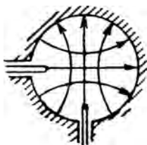
Рис. 5.21. Возбуждение двух волн типа H_{11} взаимно-перпендикулярными штырями
